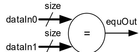
TPC: Substitua o comparador fixo de 4 bits do trabalho prático 1, por uma instanciação deste comparador parametrizável (com **size = 4**). Implemente e teste no kit DE2-115.
