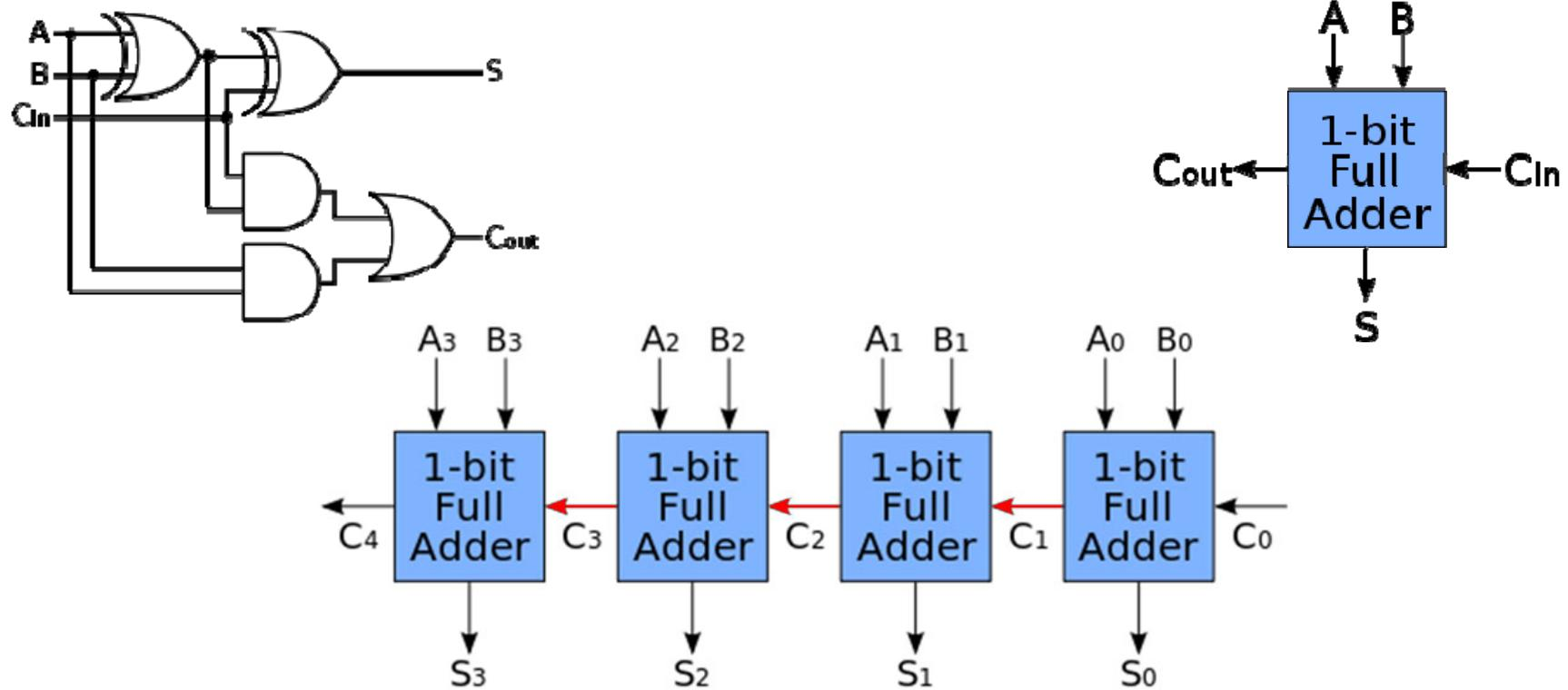
**Abordagem da parte I do guião prático 3:** modelar em VHDL um Full Adder de 1 bit (**Entity FullAdder + Architecture** contendo as equações lógicas); instanciar e interligar 4 **FullAdder** para construir um somador de 4 bits (**Entity Adder4 + Architecture**).
