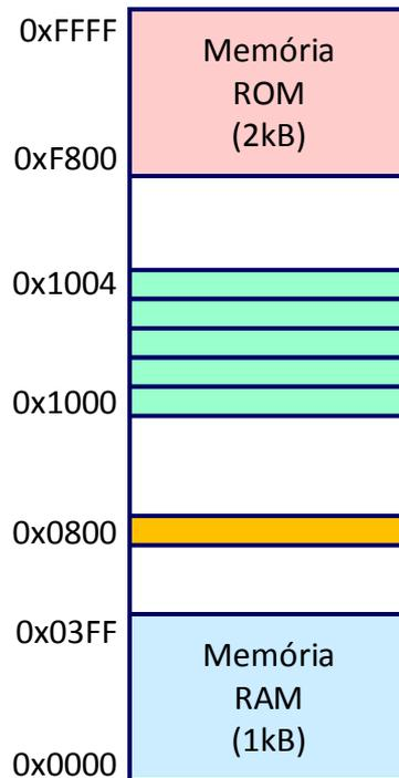
68. Para o exemplo da figura abaixo, determine a gama de endereços em que cada uma das linhas CS<sub>x</sub> está ativa, com a constante de comparação 0x00102 e admitindo que o valor de S é composto por 3 bits e N=32bits.
