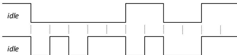
109. Um dispositivo com interface RS232, configurado para transmitir 8 bits de dados, paridade ímpar e 1 stop bits, produz a trama acima (2ª) que é recebida por outro dispositivo RS232 incorretamente configurado para 7 bits de dados, sem paridade e 1 stop bit, mas com o mesmo *baudrate*. Nestas circunstâncias, determine se no recetor vais ser detetado algum error e porquê. Caso não seja detetado nenhum erro, determine, em hexadecimal, qual o valor recebido.
