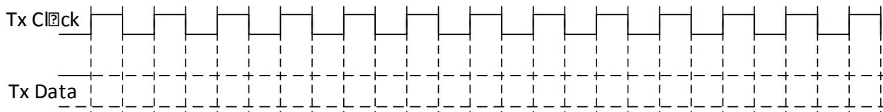
108. Um dispositivo com interface RS-232, configurado para transmitir com 7 bits de dados, paridade par e 2 stop bits, produz as duas tramas representadas nos diagramas seguintes que são recebidas por outro dispositivo RS-232 incorretamente configurado para 8 bits de dados, sem paridade e 1 stop bit mas com o mesmo *baudrate*. Nestas circunstâncias, determine se no recetor vais ser detetado algum erro e porquê. Caso não seja detetado nenhum erro, determine, em hexadecimal, qual o valor recebido.
