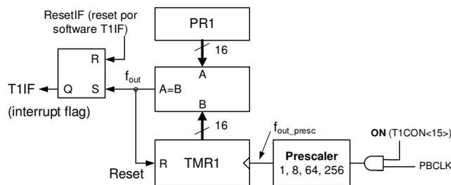
60. Considere um *timer* com reset síncrono em que a relação entre as frequências de entrada e de saída é dada por  $(k+1)$ , sendo  $k$  uma constante configurável. Determine o valor de  $k$  para as seguintes condições:
