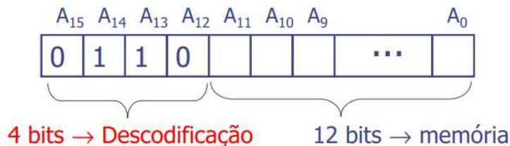
67. Escreva as equações lógicas dos 4 descodificadores necessários para a geração dos sinais de seleção para cada um dos dispositivos identificados na figura ao lado.
