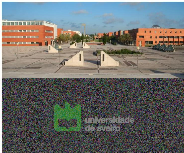
Figura 7.14: Imagem com marca de água (esteganografia) e marca de água recuperada.
