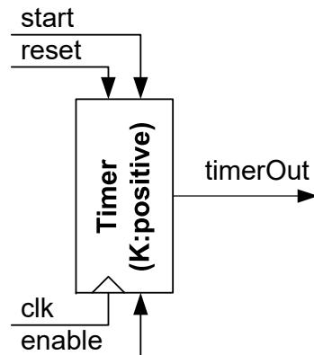
**TPC:** Desenvolver um novo temporizador em que a saída é ativada após o disparo do temporizador e desativada após ter decorrido o intervalo de tempo KT (com K programável dinamicamente)
