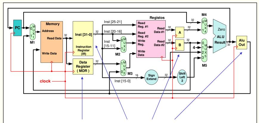
Registos adicionados à saída dos elementos operativos fundamentais para armazenamento da informação obtida/calculada durante o ciclo de relógio corrente e que será utilizada no ciclo de relógio seguinte
