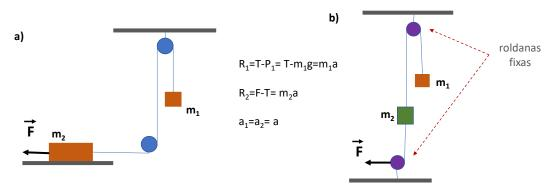
NB: As roldanas fixas servem para mudar a direcção e sentido das forças aplicadas; não diminuem a intensidade das forças aplicadas Sugestão: Fazer o diagrama de forças em cada corpo e depois aplicar a 2ª lei de Newton a cada um deles
